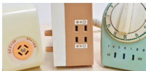
■キッチンタイマーのコンセント部分。ここに電化製品側のプラグを差し込む。
