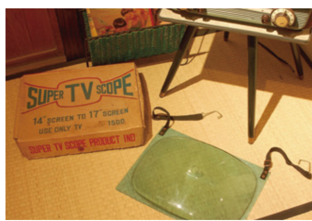
■「スーパー TV スコープ」の本体と箱。液体でみたさられているためレンズ重量は約3.3kgとかなり重い。
