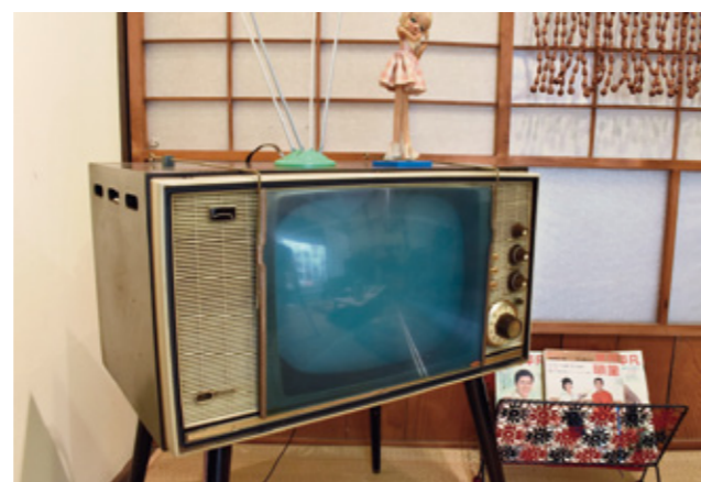
■フレネルレンズ製の拡大鏡を取り付けたテレビ。
