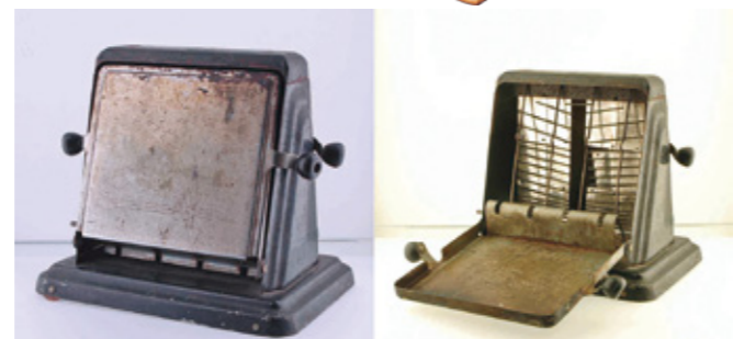
■ターンオーバー式トースター。右のように扉を開けるとパンが滑り落ち、裏返しになる。
